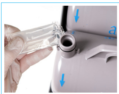
Bild. 48 Smörj in tätningar med fett
