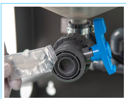
Bild. 25 Smörj in tätningssring med fett
