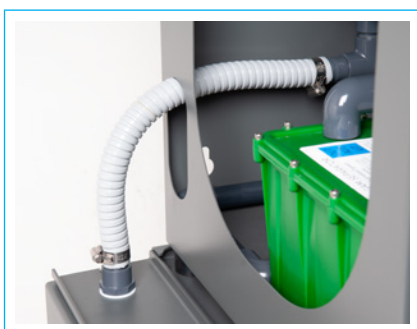
Bild. 29 Anslut slangen till bufferttanken
