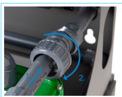
Bild. 23 Skruva fast trevägs-utloppsbyggnaden
