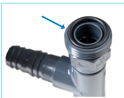
Bild. 37 Sätt in tätning
