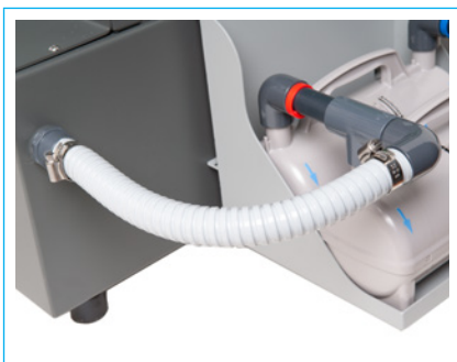
Bild. 39 Anslut slang till amalgamavskiljarna
