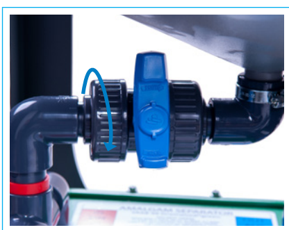
Bild. 27 Skruva fast trevägs-tilloppsbygga
